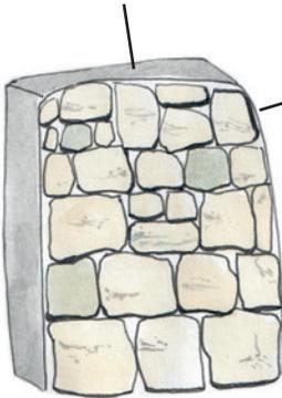
S'il n'est pas possible de construire un mur de pierres contre le béton, alors l'installation des pierres de parement jointoyées de chaux est une solution. Plus ces pierres sont épaisses, plus le mur sera vivant.
